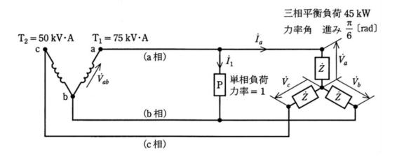
(a) 問題の図において、 $\dot{V_a}$ を基準とし、 $\dot{V_{ab}}$ 、 $\dot{I_a}$ 、 $\dot{I_1}$ の大きさと位相関係を表す図として、正しいのは次のうちどれか。
