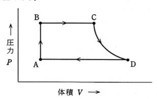
図の汽力発電の基本的な熱サイクルを (7) という。 $A \rightarrow B$  は、給水が給水ポンプで加圧されボイラに送り込まれる (4) の過程である。 $B \rightarrow C$  は、この給水がボイラで加熱され、飽和水から乾き飽和蒸気となり、さらに加熱され過熱蒸気となる (9) の過程である。 $C \rightarrow D$  は、過熱蒸気がタービンで仕事をする (1) の過程である。 $D \rightarrow A$  は、復水器で蒸気が水に戻る (1) の過程である。
