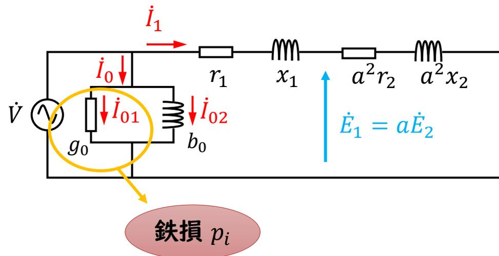
短絡試験→銅損 $p_c$ を測定する試験
