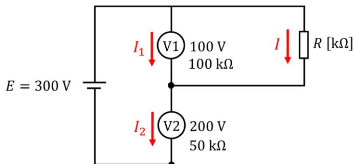
抵抗器 $R$ に流れる電流は2つの電圧計の最大許容電流の差分であり、
