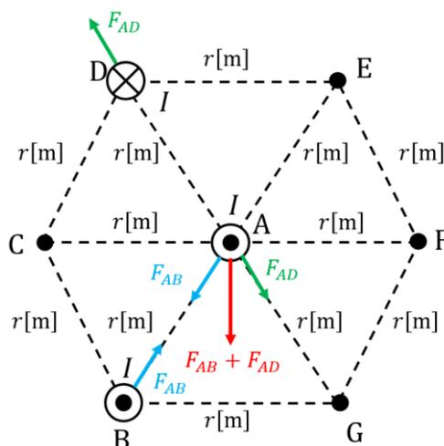
点Aの導体に生じるアンペール左向きにするためには、導体Xを点Gに配置する。力の合成は以下の図となる。
