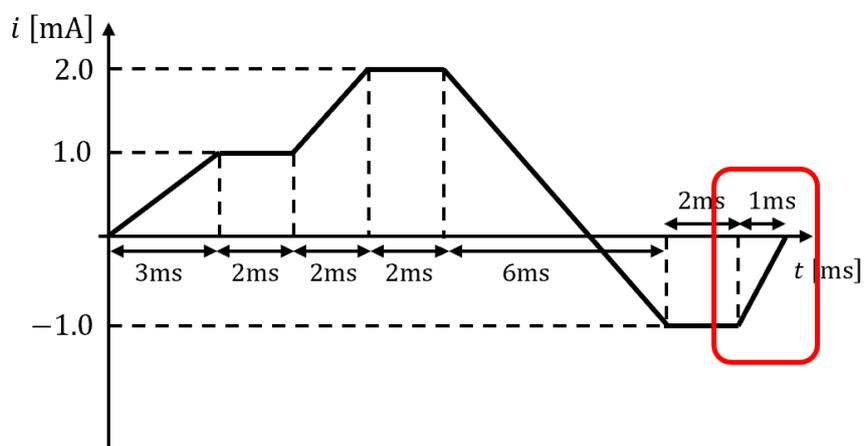
電流の時間変化量が最も大きくなるのは、図中の赤枠部分である。
