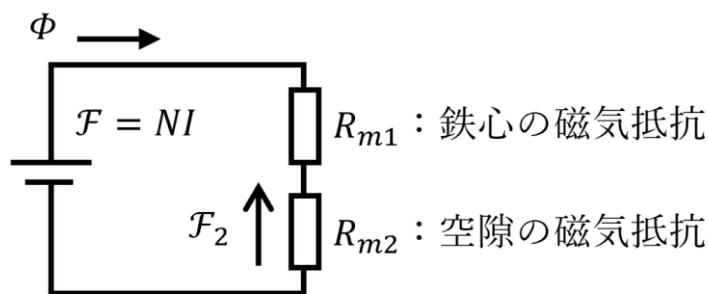
ここで、磁気回路と電気回路の類似性から各物理量を電気回路に置き換えて考えてよい。
