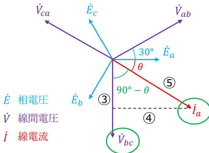
单相電力計の電流コイルは a 相に接続され、電圧コイルは b-c 相間に接続されることから、測定される電力  $P$  は、
