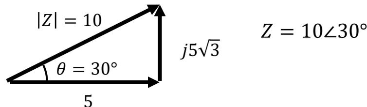
ベクトル図を描く(必ず相電圧を基準に作図する)
