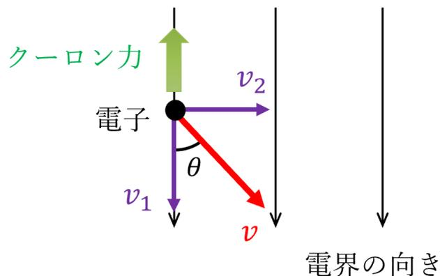
電子の初速度 $v$ を電界と水平成分 $v_1$ と垂直成分 $v_2$ に分解する。
