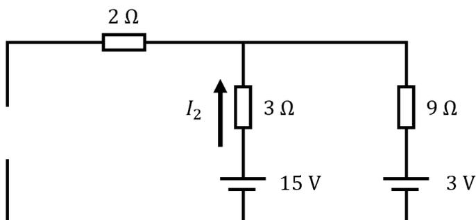
電圧源のみの回路から抵抗 $3\Omega$ に流れる電流 $I_2$ を求める。
