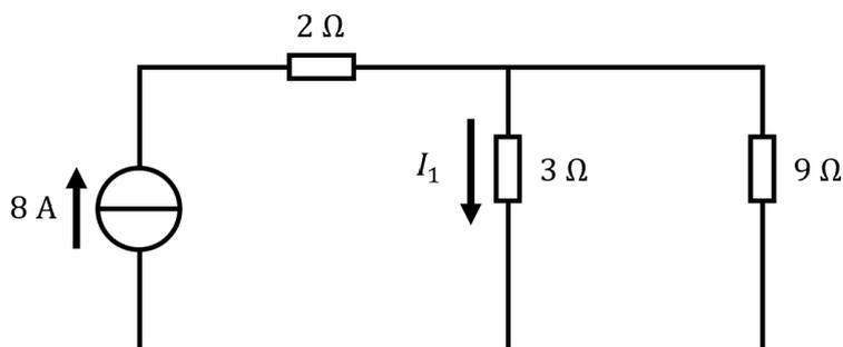
電流源のみの回路から抵抗 $3\Omega$ に流れる電流 $I_1$ を求める。
