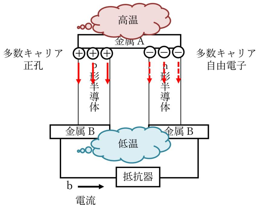
金属 A の周辺温度が高く、金属 B の周辺温度が低いと、半導体中に温度勾配が生じる。温度勾配により熱拡散が生じ、高温部から低温部に多数キャリアが移動するため、p 形半導体中では正孔、n 形半導体中では自由電子が、上から下へ移動する。n 形半導体中では、自由電子が上から下に移動するため、少数キャリアの正孔は相対的に下から上に移動する。
