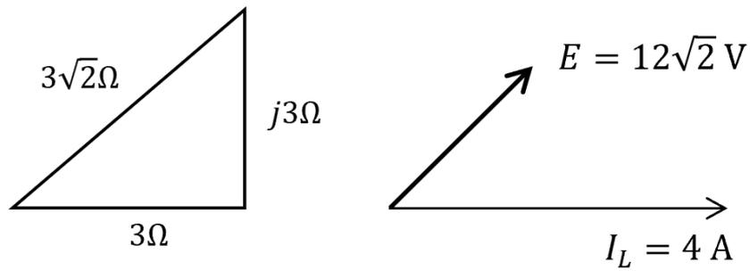
それぞれのフェーザ図において、電源電圧 $E$ は共通なので、電源電圧 $E$ を基準に電流 $I_L$ と $I_C$ のベクトルを並べると以下のようなになる。
