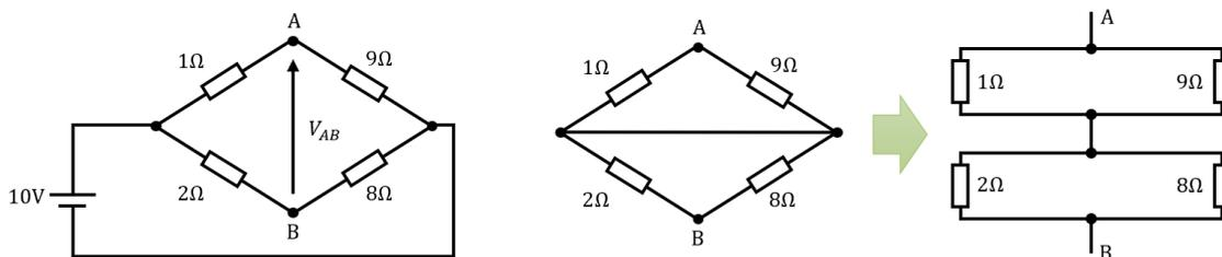
テブナンの定理を用いる。図より端子 AB 間の電圧は、
